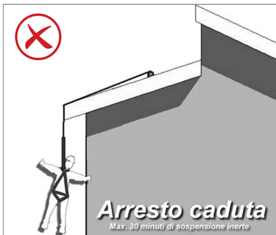
Fig. 1. Schema illustrativo arresto di caduta
