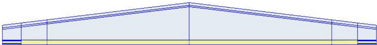
Vista laterale della trave con tracciato dei cavi.
