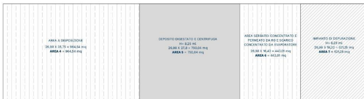
Figura 7 - Schema dimensionale del capannone di post-trattamento del digestato
