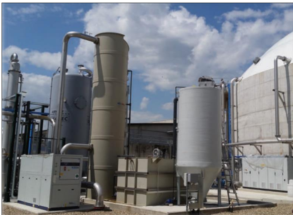
Figura 11 – Torre scrubber per abbattimento dell'acido solfidrico
