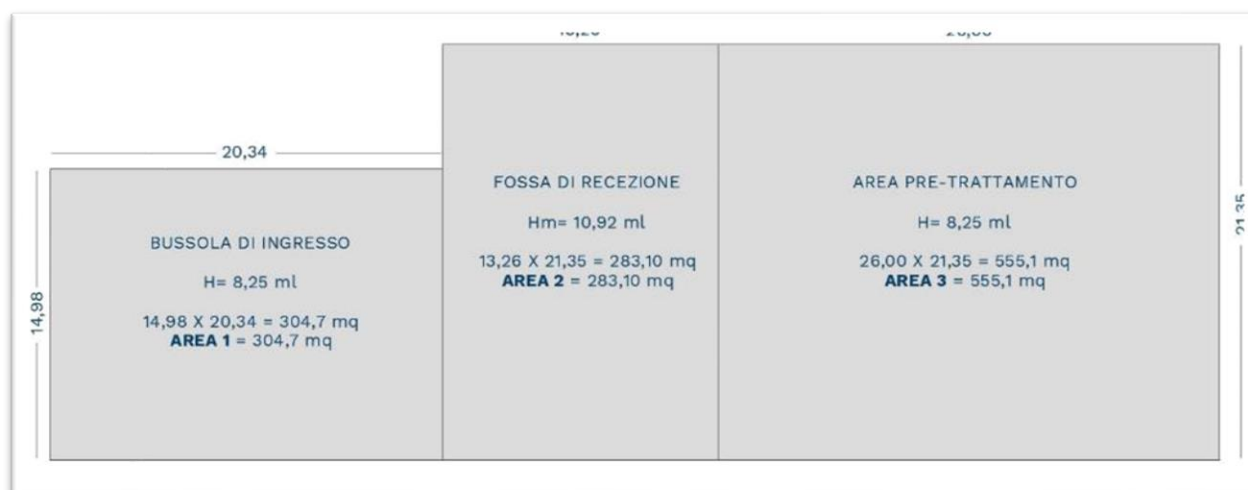
Figura 3 – Schema dimensionale del capannone di ricezione e pretrattamento
