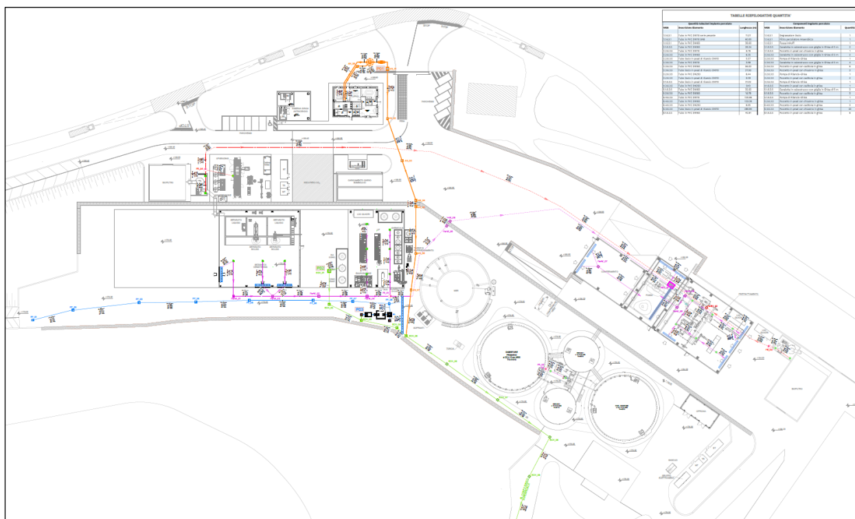
Figura 12 Rappresentazione planimetrica delle reti di captazione dei reflui e percolati dell'impianto
