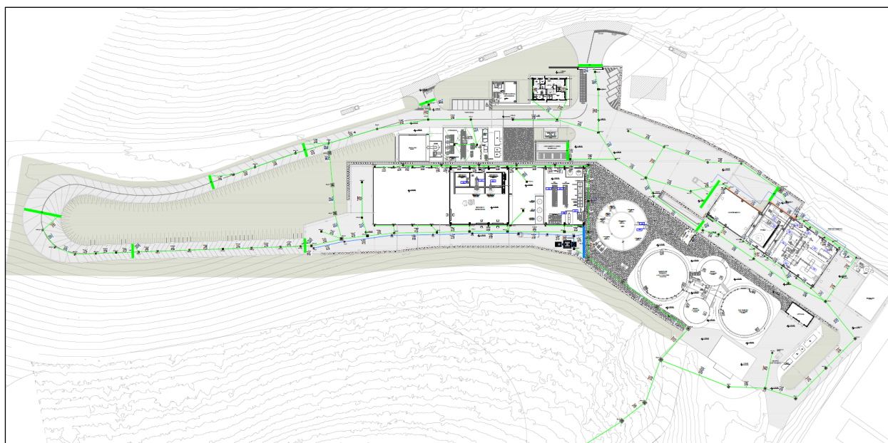
Figura 10 Rappresentazione del sistema di captazione delle acque meteoriche dell'impianto
