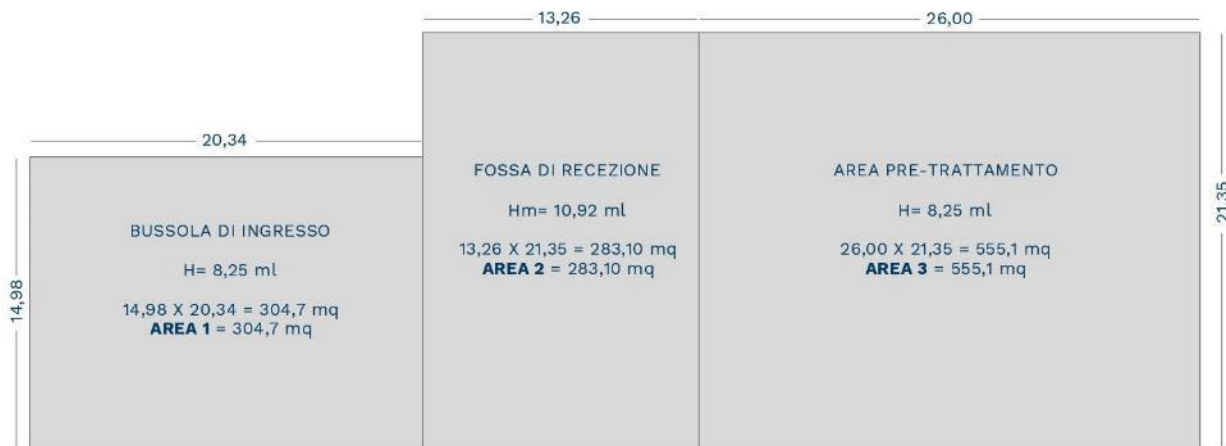
Figura 3 – Schema dimensionale del capannone di ricezione e pretrattamento
