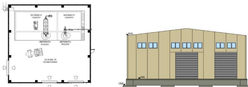
Figura 7 – Planimetria e prospetto Ovest del capannone di post-trattamento del digestato
