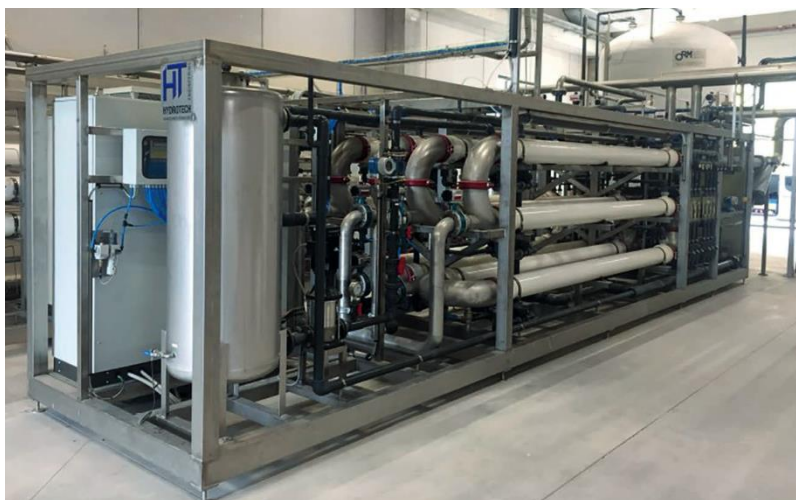
Figura 4 Membrane di ultrafiltrazione pre-assemblate su skid
