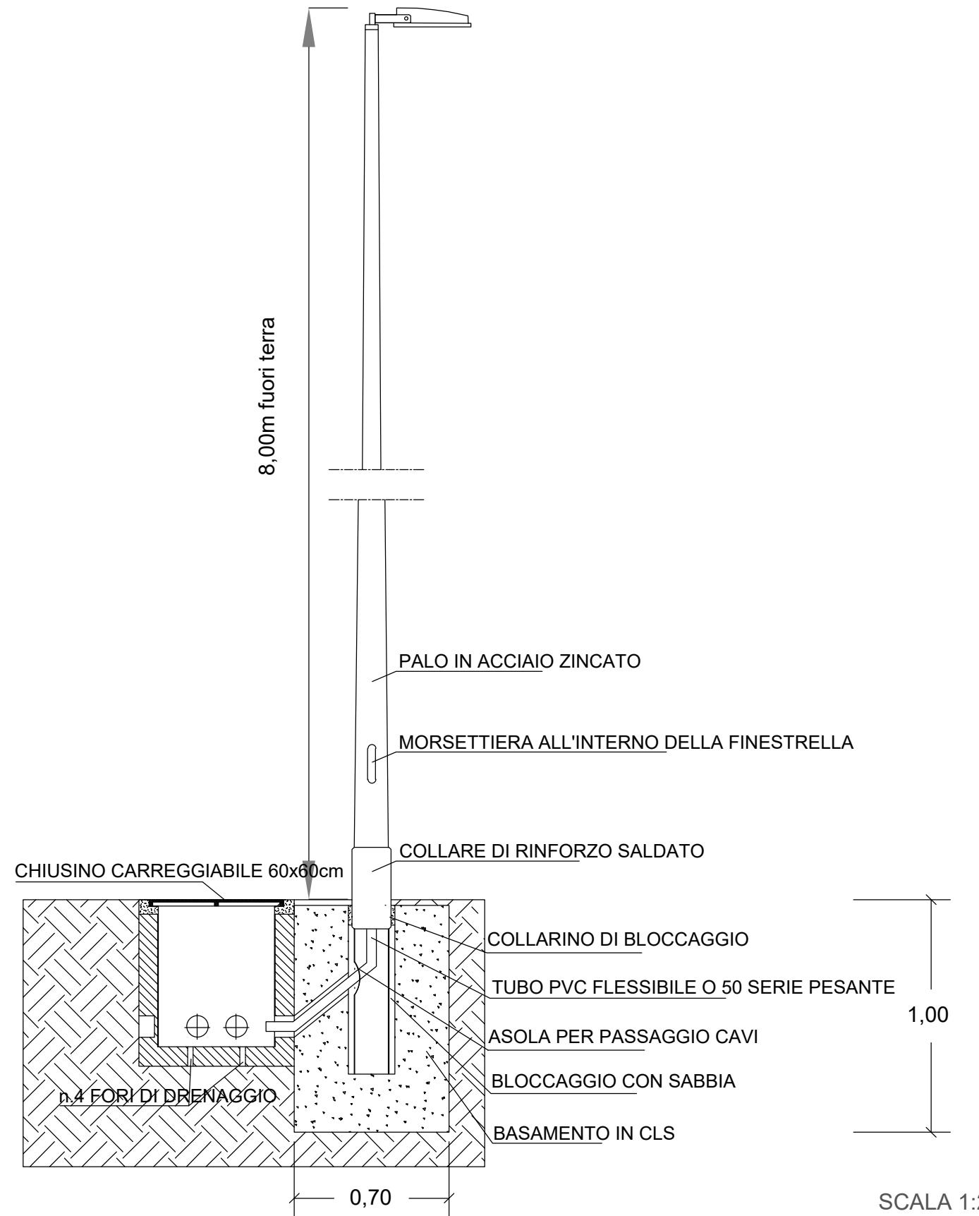
PARTICOLARE FISSAGGIO PALO A MURO
