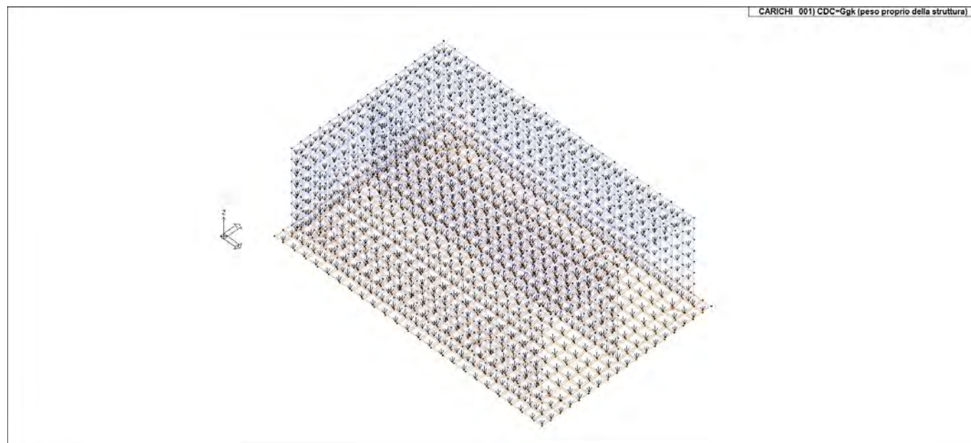
Figura 11 - CDC_001_CDCGgk peso proprio della struttura
