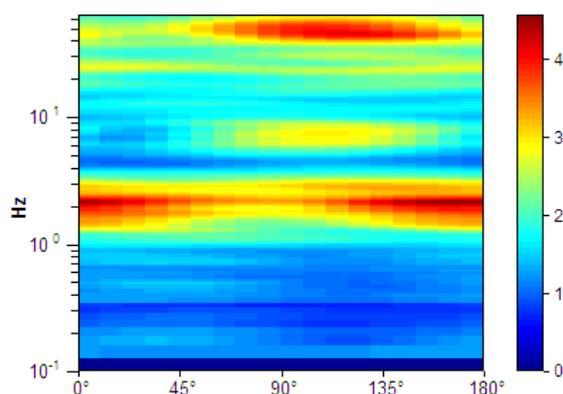
**Picco H/V a  $2.13 \pm 0.06$  Hz (nell'intervallo 0.0 - 20.0 Hz).**
