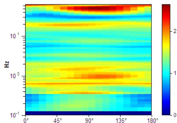
**Picco H/V a  $0.59 \pm 0.13$  Hz (nell'intervallo 0.0 - 20.0 Hz).**
