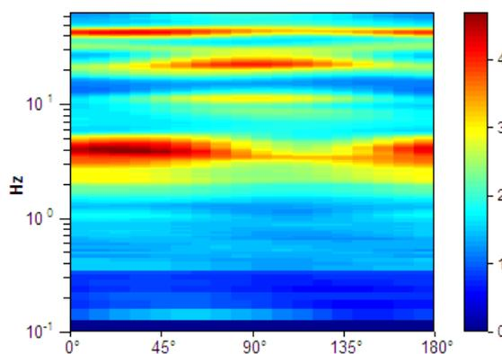
**Picco H/V a  $3.75 \pm 0.19$  Hz (nell'intervallo 0.0 - 20.0 Hz).**
