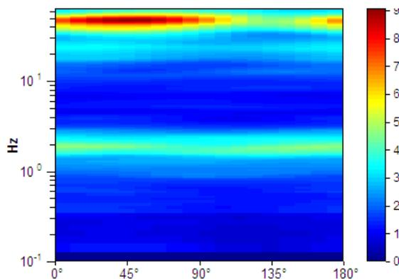
**Picco H/V a  $1.81 \pm 0.05$  Hz (nell'intervallo 0.0 - 20.0 Hz).**
