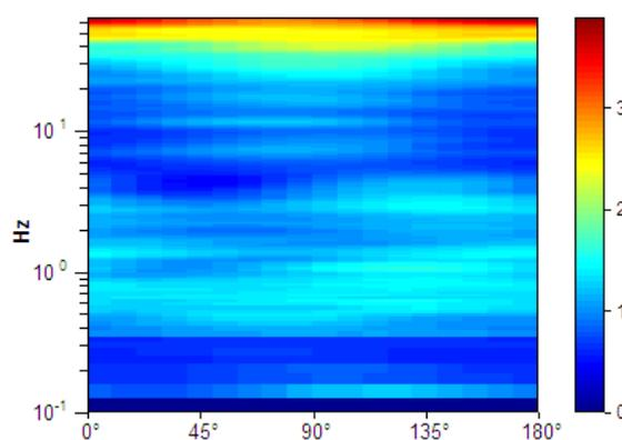
**Picco H/V a  $0.59 \pm 0.01$  Hz (nell'intervallo 0.0 - 20.0 Hz).**
