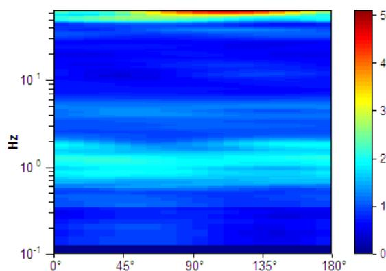
**Picco H/V a  $1.25 \pm 0.1$  Hz (nell'intervallo 0.0 - 20.0 Hz).**
