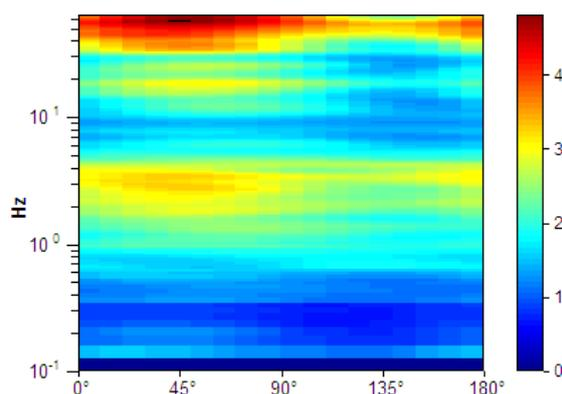
**Picco H/V a  $3.31 \pm 2.37$  Hz (nell'intervallo 0.0 - 20.0 Hz).**
