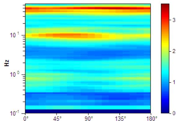
**Picco H/V a  $9.94 \pm 0.62$  Hz (nell'intervallo 0.0 - 20.0 Hz).**
