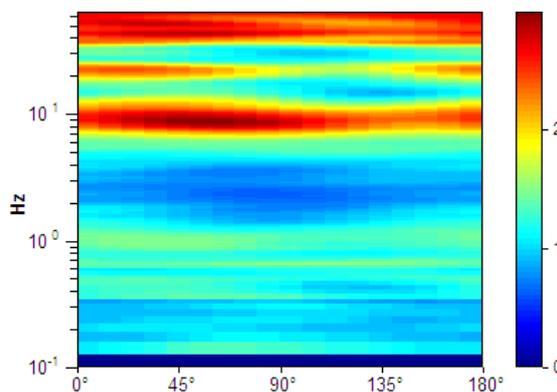
**Picco H/V a  $8.75 \pm 1.01$  Hz (nell'intervallo 0.0 - 20.0 Hz).**
