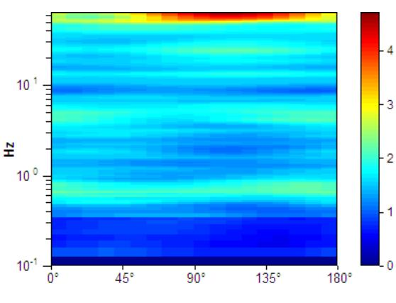
**Picco H/V a  $0.63 \pm 0.76$  Hz (nell'intervallo 0.0 - 20.0 Hz).**
