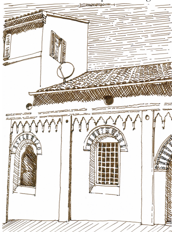
Errato posizionamento in copertura della parabola, pienamente visibile da pubblica via e installata su edificio di particolare valore storico-architettonico
